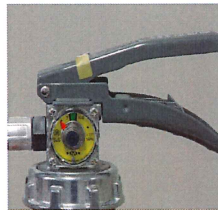
× 安全栓の脱落
