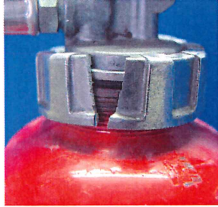
× キャップの破損
