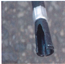
× ノズルの破損
